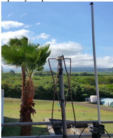
Fig. 1. Antenne R-QFH (à gauche) et antenne ADS-B (à droite).
